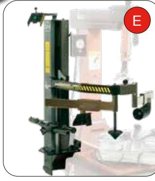
**DISPOSITIVO PNEUMATICO UNIVERSALE UPH & BPS (OPTIONAL):** Attrezzatura pneumatica ausiliaria UPH che assiste l'operatore durante il montaggio e lo smontaggio di ruote ribassate o particolarmente difficili come le «Run-Flat». Tale dispositivo brevettato evita di dover utilizzare la leva durante lo smontaggio del secondo tallone. Generalmente fornito completo di secondo pressore flottante BPS.
