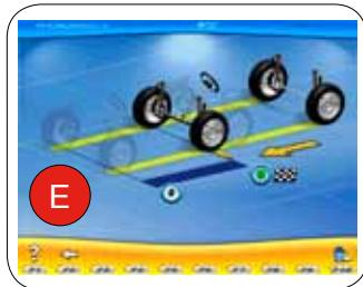
**IT** **PROGRAMMA DI COMPENSAZIONE «RUN-OUT»:** Programma ROC a spinta per compensare eventuali errori di «Run-Out» della ruota e possibili imperfezioni di accoppiamento griffa-cerchione. I valori di compensazione sono calcolati simultaneamente sulle 4 ruote favorendone una rotazione di soli 30°.
